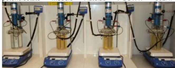
Figura 1 – Fotografia de células de corrosão padrão em vidro (1 L) utilizadas nos experimentos eletroquímicos.
