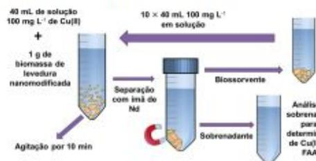
**Figura 1:** Esquema para a realização dos testes de capacidade de sorção do biossorvente de levedura nanomodificada.
